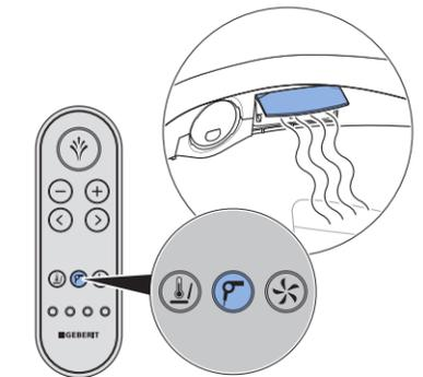
**i** Die Föhnfunktion kann während eines Duschvorgangs über die Taste <Föhn> gestartet werden. Der Föhnvorgang unterbricht die Duschfunktion.
