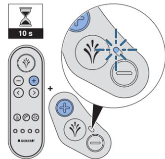
▶ Drücken Sie gleichzeitig die Taste <+> auf der Fernbedienung und die Taste <+> auf dem seitlichen Bedienfeld für circa 10 Sekunden.
